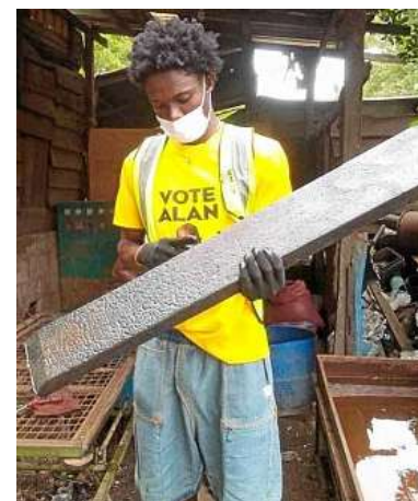
Eines der Ergebnisse des Pilotprojekts: Aus dem Plastikmüll werden Planken gepresst, die später zu Möbeln verarbeitet werden.
